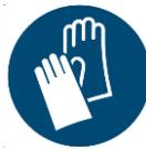
Die Temperatur am Aufstellungsort sollte innerhalb des im Datenblatt angegebenen Temperaturbereichs liegen. Bevor Tätigkeiten am Druckverstärker ausgeübt werden müssen, diesen abkühlen bzw. erwärmen lassen oder hitze- bzw. kältebeständige Schutzhandschuhe tragen.
